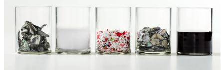
Sledećih pet proizvoda se dobija ponovo iz upotrebljenih konzervi: lim, tečni gas (TRIGAS®), plastična masa PE/PP, aluminijum i prepolimer (PREPUR®).
