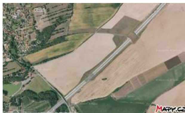
Obr. 11.2 Zelený most na dálnici D1 u Suchdolu nad Odrou (Česká republika) byl postaven na významném migračním koridoru mezi dvěma horskými pásmy (Beskydy a Jeseníky). Křížení migračního koridoru s dálnicí se bohužel nachází v zemědělské krajině bez lesního porostu. Pro zvýšení efektivnosti zeleného mostu byl proto zakoupen navazující pozemek, na němž je plánována výsadba vegetace, která spojí zelený most s nejbližším souvislým lesním porostem. © Mapy.cz
