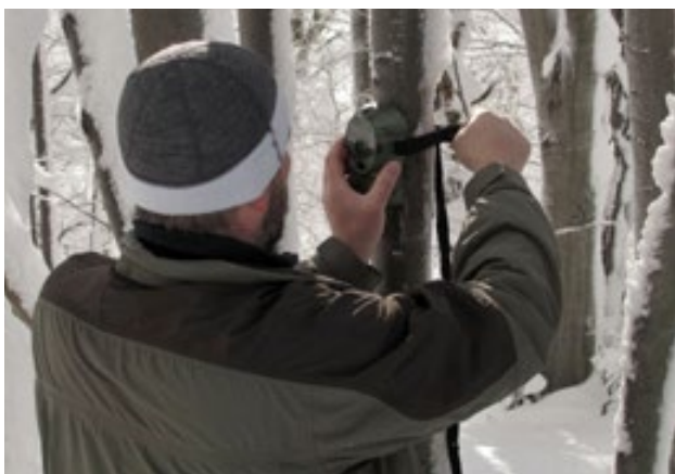
Obr. 12.12 Nejběžnější metodou hodnocení efektivnosti průchodů pro faunu je využití fotopastí. Musí být instalovány nejen v místě samotného průchodu, ale i v jeho okolí. To umožňuje ověřit, která zvířata průchod nepoužila. © Michal Kalaš
