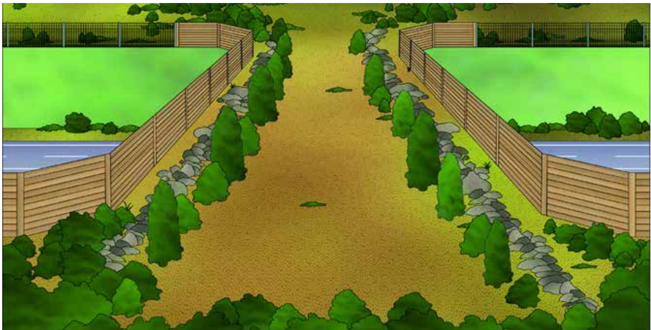
Рис. 10.22. Загальна схема зеленого мосту. Такий перехід для фауни повинен бути обладнаний бар'єрами, які усувають шум, світло від транспорту та інші перешкоди. Рослинність насаджується по краях переходу, а центральна частина залишається відкритою (Джерело: Spain. Ministry for Ecological Transition. 2016. Technical prescriptions for wildlife crossing and fence design (second edition, revised and expanded) (on line). Madrid: MAPAMA. Illustrations made by Pep Gaspar, ARTENTRAÇ.)
