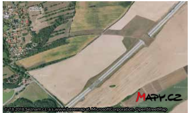
Рис. 11.2. Зелений міст на автомагістралі D1 (Suchdol nad Odrou, Czech Republic) був побудований на міграційному коридорі між двома гірськими хребтами Бескиди та Єсеніки. Проте він був розташований поруч із сільськогосподарським ландшафтом без лісового покриву. Таким чином, з метою підвищення ефективності зеленого мосту було придбано сусідню землю для насадження нової рослинності, яка повинна з'єднати зелений міст із лісовим масивом. © Mapy.cz
