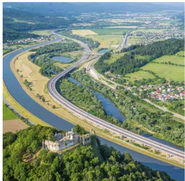
Рис. 5.8. Формування об'єднання лінійних структур об'єктів транспортної інфраструктури (штучний канал і автомагістраль) у долині Вах є непроникним бар'єром для більшості видів диких тварин. © Архів NDS
