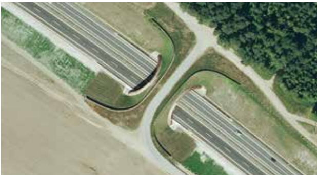
Рис. 6.34. Багатоцільове використання мостів є найкращим рішенням з фінансового погляду. Проте інколи мости можуть бути перезавантажені рухом людей й машин, тоді тварини їх оминатимуть. Попрад, Словаччина. © EUROSENSE s.r.o., 2010
