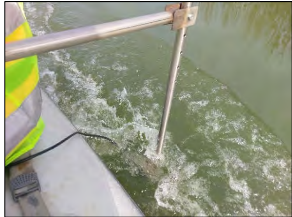
3.2. kép – A szonárt rögzítő karosállvány
