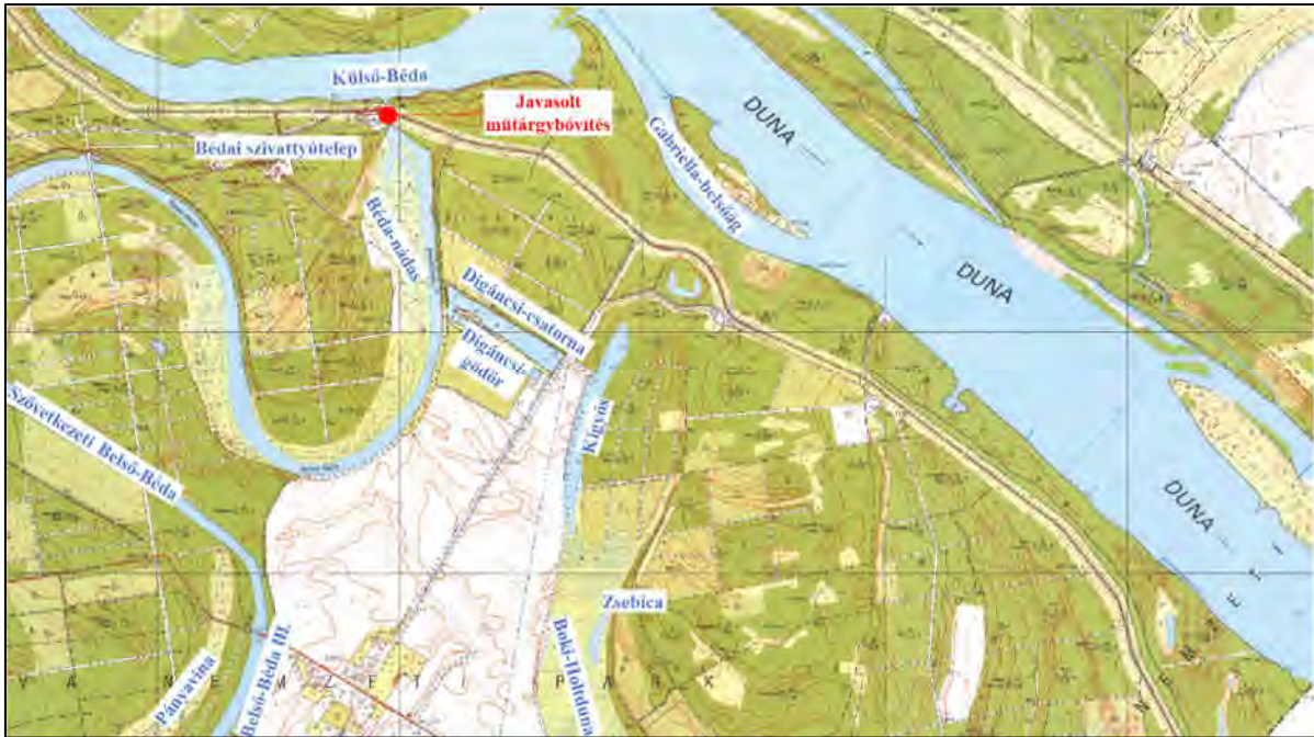
5.3. ábra – Belső-Béda javasolt vízpótlása szivattyútelep bővítésével (3. koncepció)
