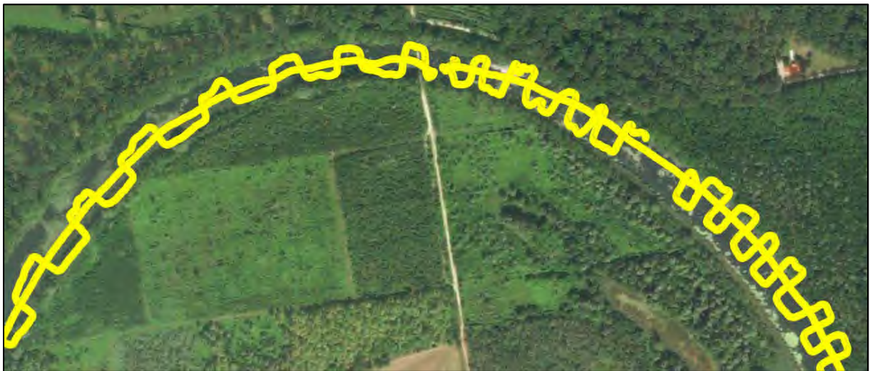
3.2. ábra – A mederfelmérés során alkalmazott felmérési mintázat
