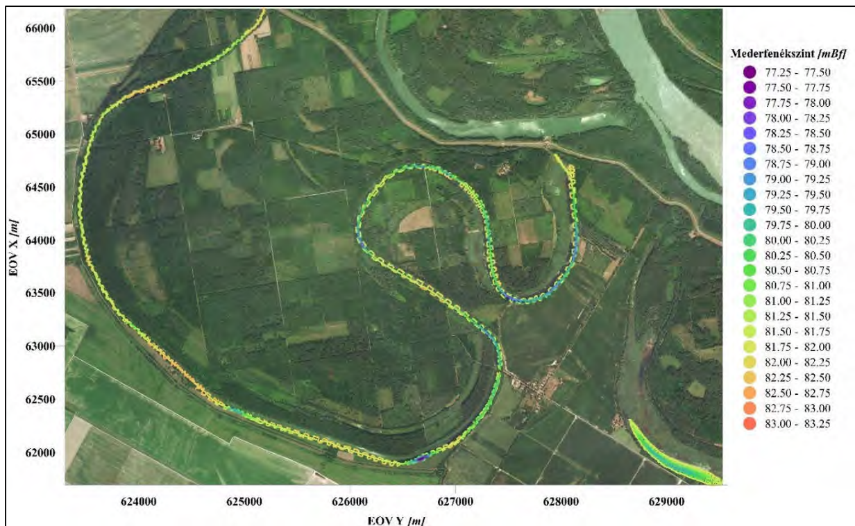
3.4. ábra – A 2020. február 11-12-én végzett mederfelmérés során rögzített mérési pontok Balti feletti magassága (műholdkép forrása: Bing)
