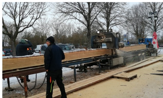
Foto dreapta: Gaterul mobil de la Bremen a reușit taie lungimi de până la 19,30 m, ceea ce era necesar datorită scândurilor continue ale bărcii (Fotografie de Margit Schedel).
