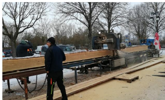
Foto vpravo: Mobilní pila z Brém byla schopna řezat nadměrné délky až 19,3 m, což bylo nutné kvůli průběžným prkům lodi. (Foto: Margit Schedel).
