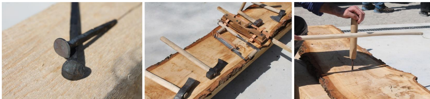
Foto: Miriam Sapio (zleva doprava): Ručně kované římské hřebíky, sortiment rekonstruovaných římských nástrojů, římský vrták v akci.
