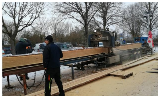
Slika desno: Mobilna pilana iz Bremena je mogla da obradi drvo do dužine 19,30 m, što je bilo neophodno zbog neprekidnih daski na čamcu (Slika Margit Šedel).
