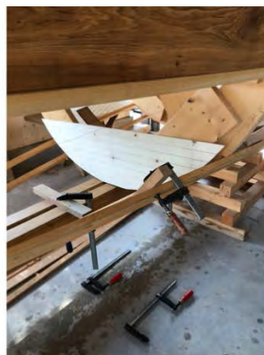
Srednja slika: Ovaj šablon od topole će kasnije ustupiti mesto hrastovoj podnoj ploči (Izvor: Boris Dreier)
