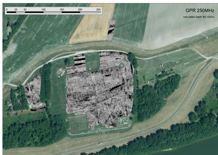
© LBI ArchPro: Nalevo: Souhrnné zobrazení GPR průzkumu s 250 MHz anténami; Napravo: Archeologické interpretáční mapování GPR průzkumu římské pevnosti v Iže.
