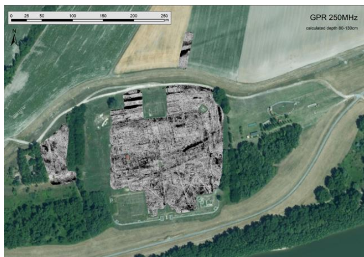
Fotografie od LBI ArchPro: vlevo: Přehled georadarového průzkumu s anténami 250 MHz; vpravo: Archeologické interpretační mapování georadarového průzkumu římské pevnosti v Iži.
