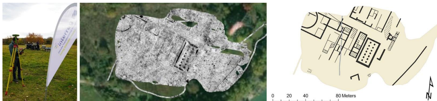
Fotografie od LBI ArchPro: Foto vlevo: Nastavení georadaru v Százhalombatta; Foto uprostřed: Zkoumané pole v oblasti římské pevnosti; Foto vpravo: Interpretace georadarových dat zobrazující římské stavební struktury.
