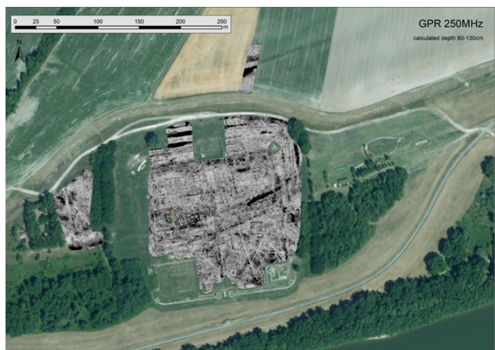
© Институт „Болцман“. Вляво: Изглед от георадарното проучване с антени 250 MHz; вдясно: археологическо разчитане на георадарните проучвания на римската крепост при Ижа.
