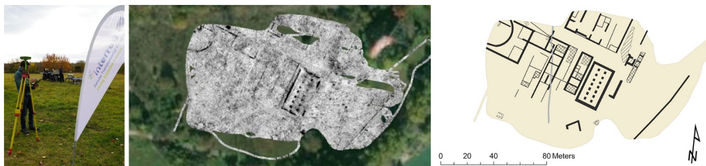
Bal oldali fotó: A GPR rendszer felállítása Százhalombattán. Középső fotó: Felmérési terület a római kori erőd területén; jobb oldali kép: A GPR adatok értelmezése, bemutatva a római kori épületszerkezeteket. Fotó: LBI Arch Pro.
