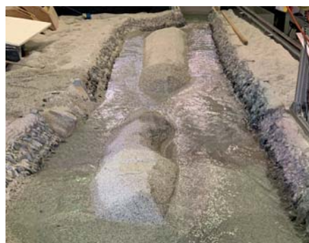
27. ábra: Fizikai modellezés a Mura szélesítéséhez Gosdorfnál (Stájerország, Ausztria)
