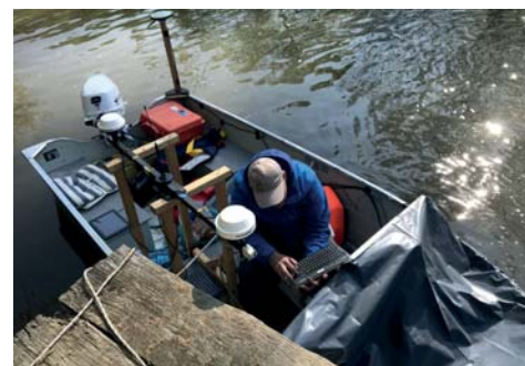
25. ábra: A Mura mederfenék-vizsgálata modern szonár- és lézertechnológiával felszerelt csónakkal
